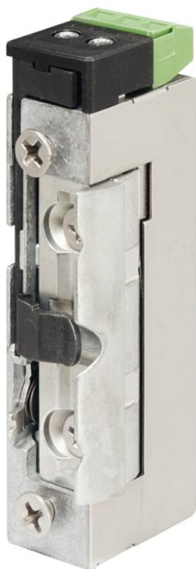
Modell mit Rückmeldekontakt als potentialfreier Wechselkontakt. Dieser wird von der Schlossfalle betätigt. Zusätzlich hat das Modell die Möglichkeit einer mechanischen Entriegelung (Tagesentriegelung) der Türöffnerfalle.
