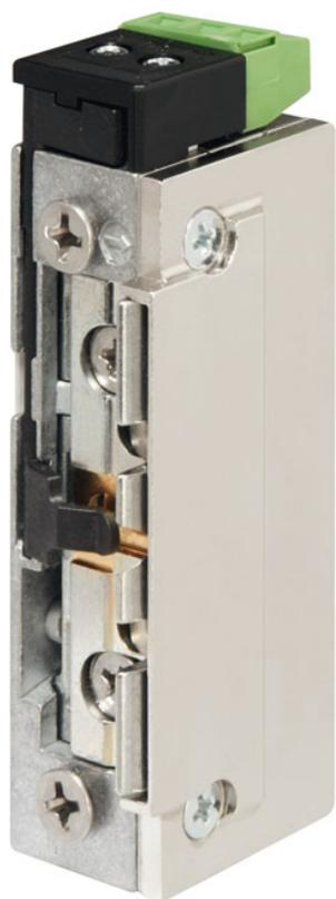
Modell mit bipolarer Schutzdiode. Rückmeldekontakt als potentialfreier Wechselkontakt. Dieser wird von der Schlossfalle betätigt.
